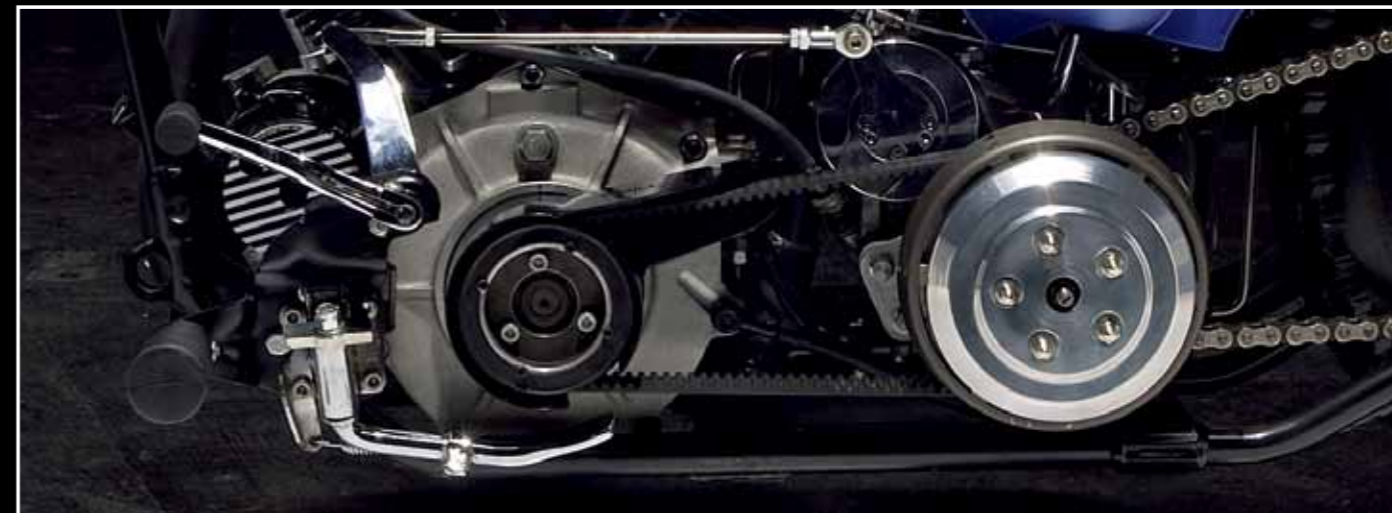
Luftige Verbindung: Der 1,5 Zoll-Belt zwischen Motor und Getriebe arbeitet im Freien. Schlaghosen werden gnadenlos aufgefressen
