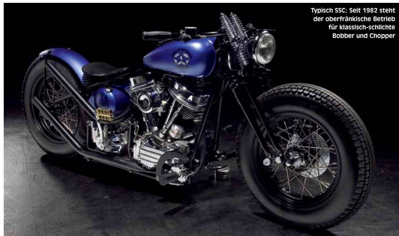
Authentisch: Fußrasten und Hebeleien aus Stahl ersetzen die Trittbretter
