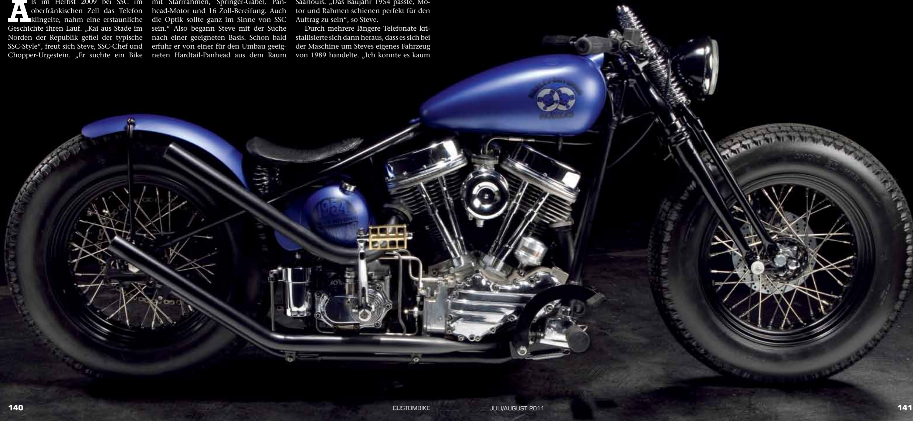
Luftige Verbindung: Der 1,5 Zoll-Belt zwischen Motor und Getriebe arbeitet im Freien. Schlaghosen werden gnadenlos aufgefressen
