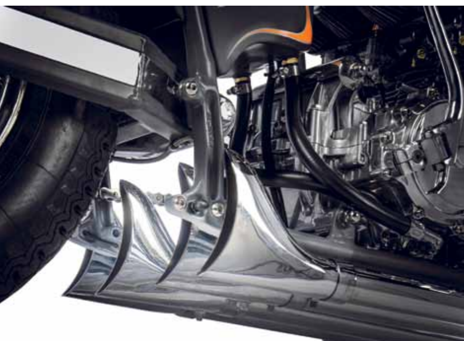
Kurze Krümmerrohre, vier Fishtail-Endtöpfe, die noch vor der Schwinge enden. Nichts lenkt damit von der traditionell gehaltenen Heckpartie ab, die mit Extrem-Speichenrad samt Ritzelbremse eine Spezialität der Firma SSCycle ist
