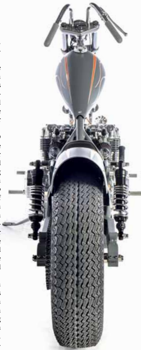
Autoreifen auf 15-Zoll-Felgen waren an früheren Schwedenchoppern keine Seltenheit, für das BBO-Bike war dieses Detail gerade recht
