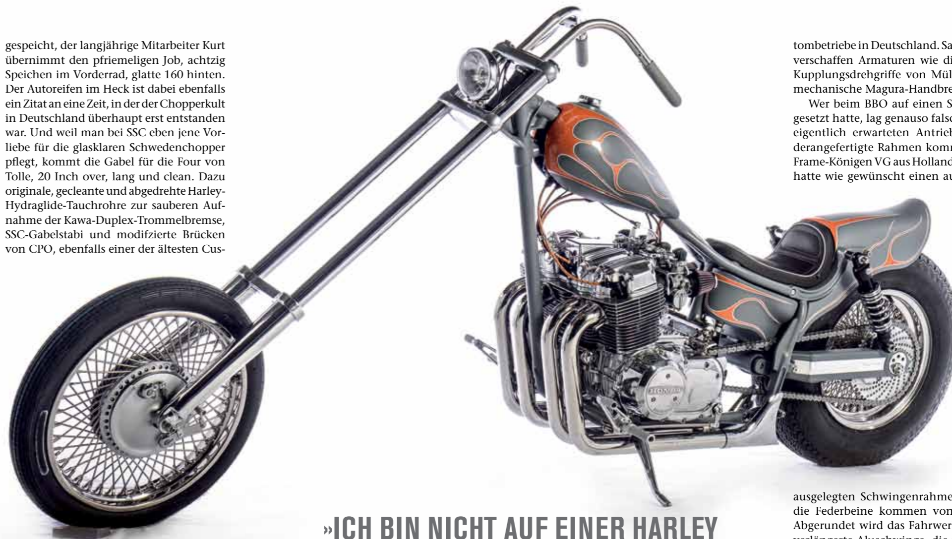
Kurze Krümmerrohre, vier Fishtail-Endtöpfe, die noch vor der Schwinge enden. Nichts lenkt damit von der traditionell gehaltenen Heckpartie ab, die mit Extrem-Speichenrad samt Ritzelbremse eine Spezialität der Firma SSCycle ist
